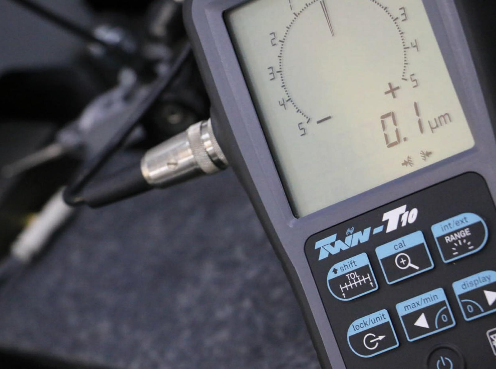
La scala con 200 divisioni del TWIN-T10 consente una visualizzazione al micron durante misure geometriche.
