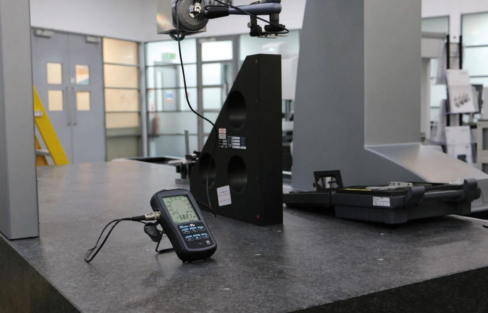
Allineamento meccanico dell'ortogonalità ZX di una CMM con il TESA TWIN-T10.
