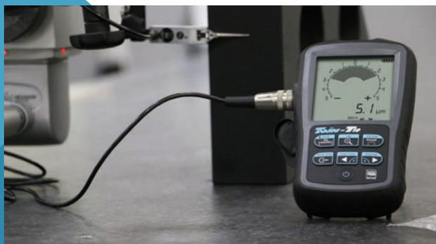
L'allineamento è facilitato dalla funzione di auto-range della scala del visualizzatore TESA TWIN-T10.
